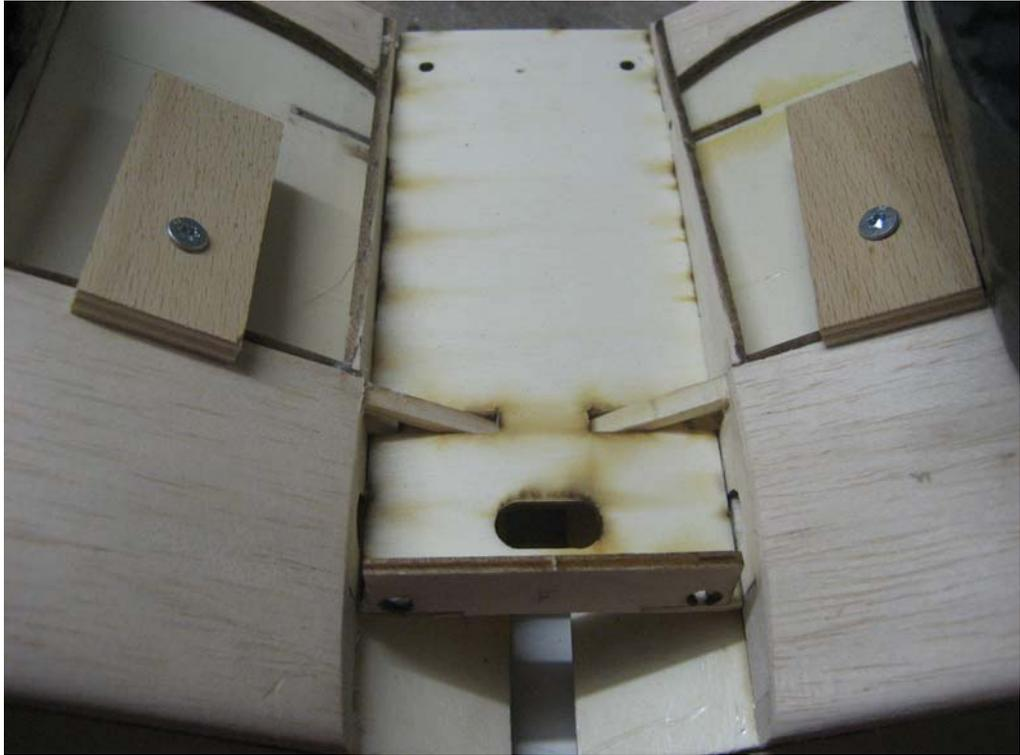
Beide Hellingseiten mit den Tragflächenhälften zusammenschieben und das Mittelbrettchen einfädeln. Auch der senkrechte Dübelhalter kann jetzt schon eingeklebt werden. Alles sauber gerade ausrichten und verleimen.
