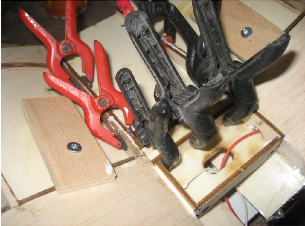
Die Verstärkungsrippen und die hintere Dübelaufnahme muss jetzt eingeleimt werden.
