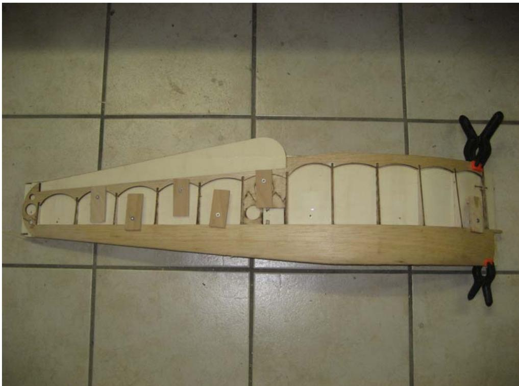
So sollte dann eine Tragflächenhälfte aussehen. Die gebügelte Beplankung wird auf jeden Fall top halten!
