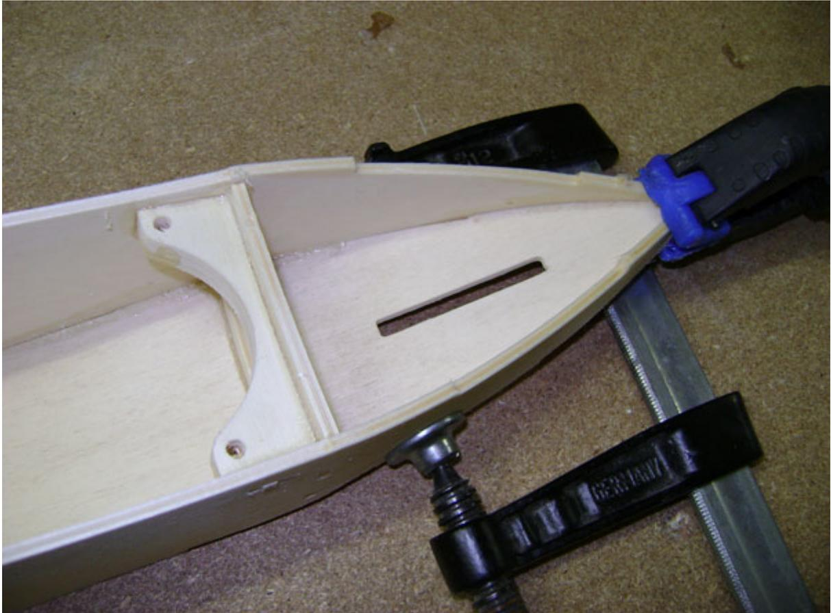
Rumpfhinterteil von außen nass machen und zusammenziehen. Alles fixieren und aushärten lassen.
