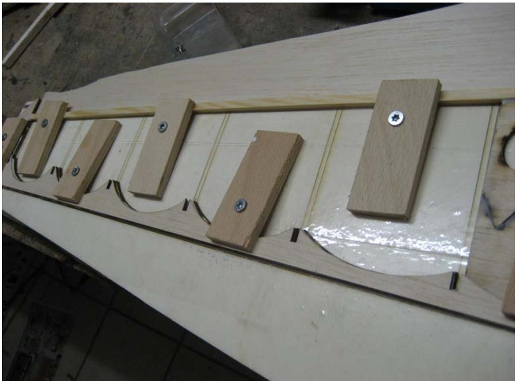
**Die Endleistenoberseite nach den Aussparungen der Rippen ausrichten und beim Leimen fixieren.**
