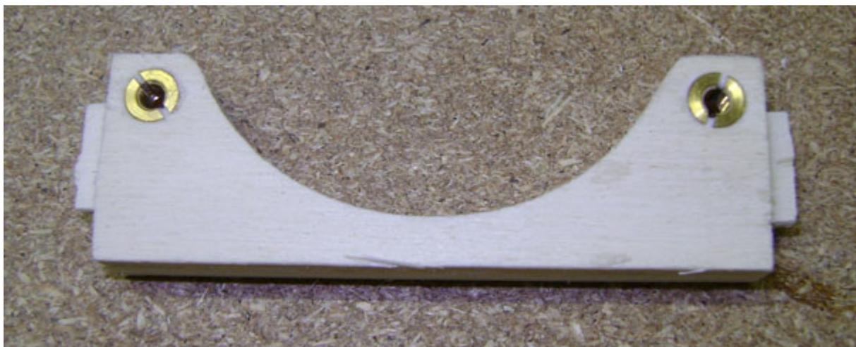
Die 3 Sperrholzteile für die Flächenbefestigung hinten, zum Block verleimen und Gewindeeinsätze M3 einkleben.
