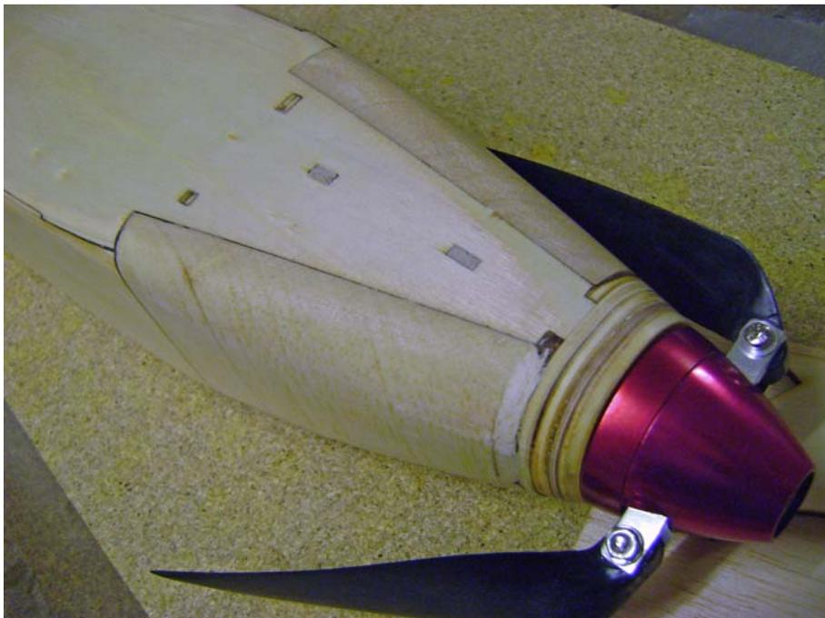
Den Motor mit Spinner montieren und vorne am Abschlussring die Spinneraußenkante (Durchmesser 40mm) sauber anzeichnen. Dann alles wieder rausbauen und in Form schleifen. Das Ergebnis ist auf diesem Bild zu sehen. Idealerweise hat der Spinner einen umlaufenden Spalt von nicht mehr als 0,3mm.
