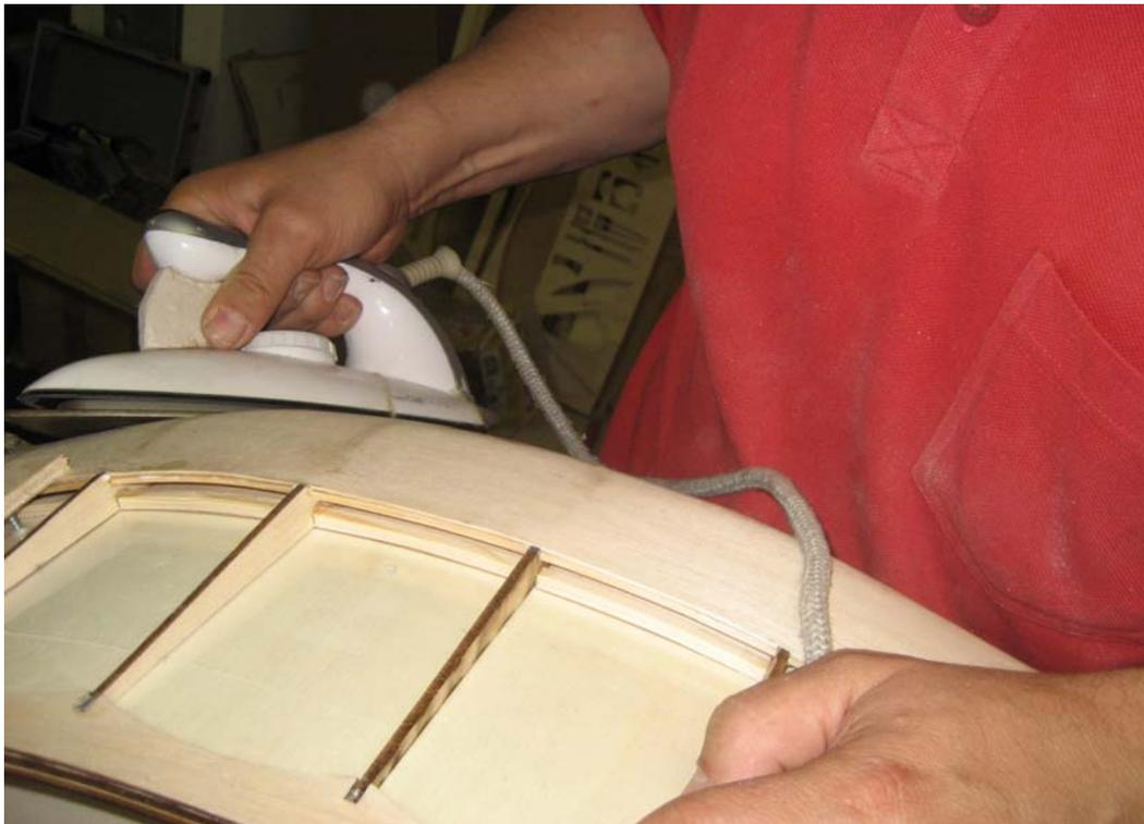
Von hinten nach vorne (in Flugrichtung) kann nun Die Beplankung angebügelt werden.
