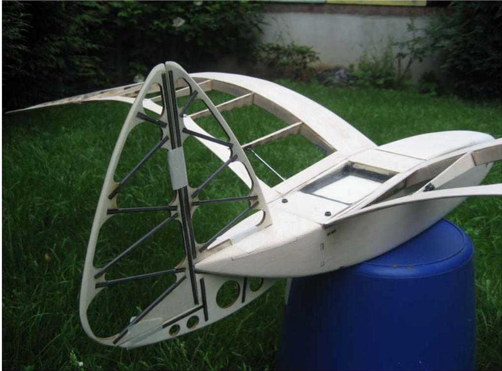
Die Tragfläche kann jetzt schon mal an den Rumpf eingepasst werden. Auch das SLW kann jetzt, zur probe eingesteckt werden. Achtung! auf dem Bild ist noch der erste Prototyp dargestellt. Das originale SLW ist größer!
