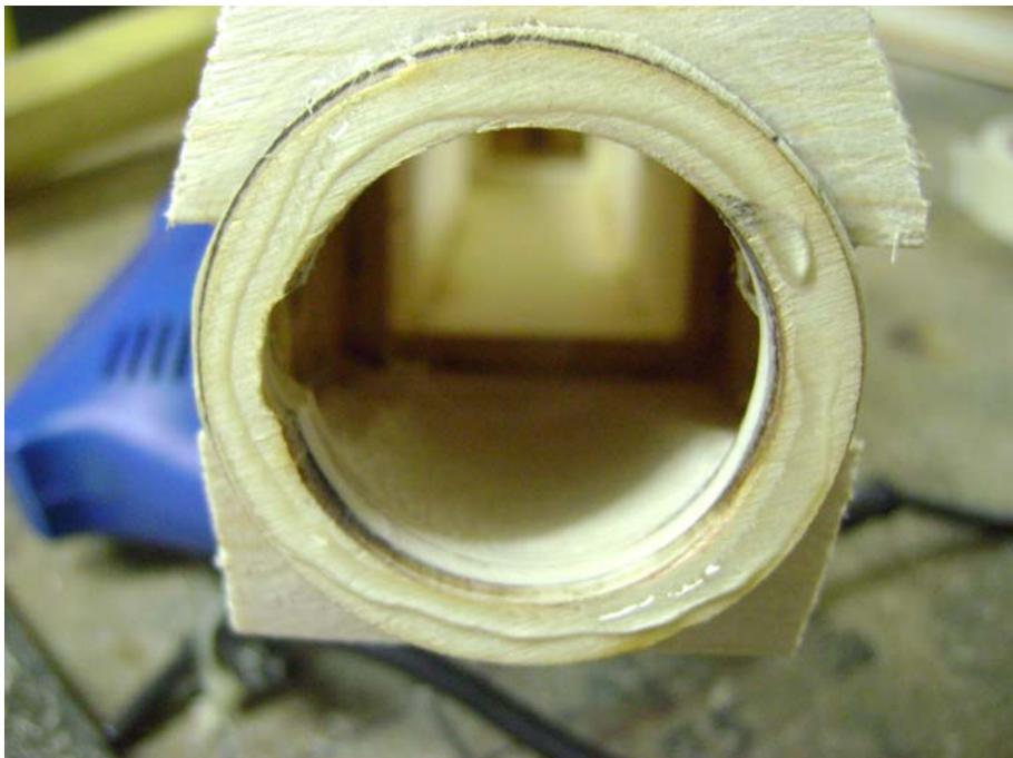
Dann vorne/ innen die Balsaklötze aushöhlen, damit später der Motor reinpasst. Es könnten Motoren mit maximalen Außendurchmesser von 36mm verwendet werden.
