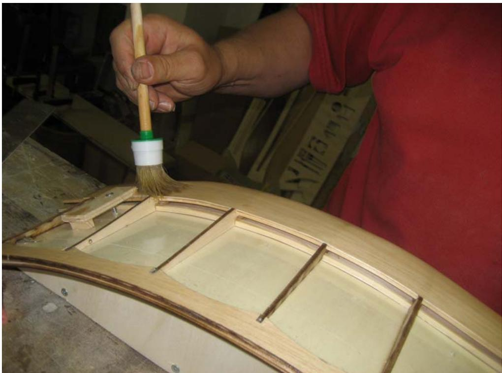
Die Beplankung nochmal mit Wasser einpinseln, damit die Spannungen rausgehen. Dann gut trocknen lassen.
